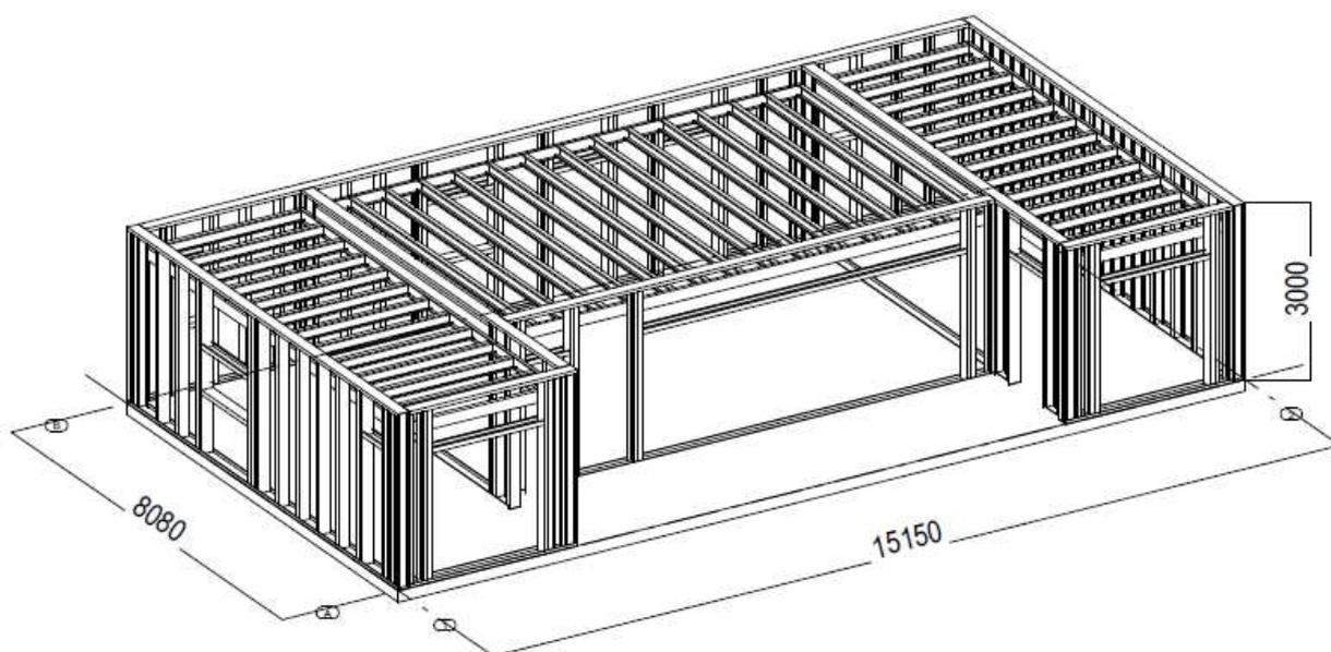
Ensemble de structures assemblées par vis auto-perceuses et/ou par boulons.
